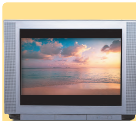
► Televisor com tela em formato 4:3 e imagem em formato widescreen (16:9) (imagem sem escala).
